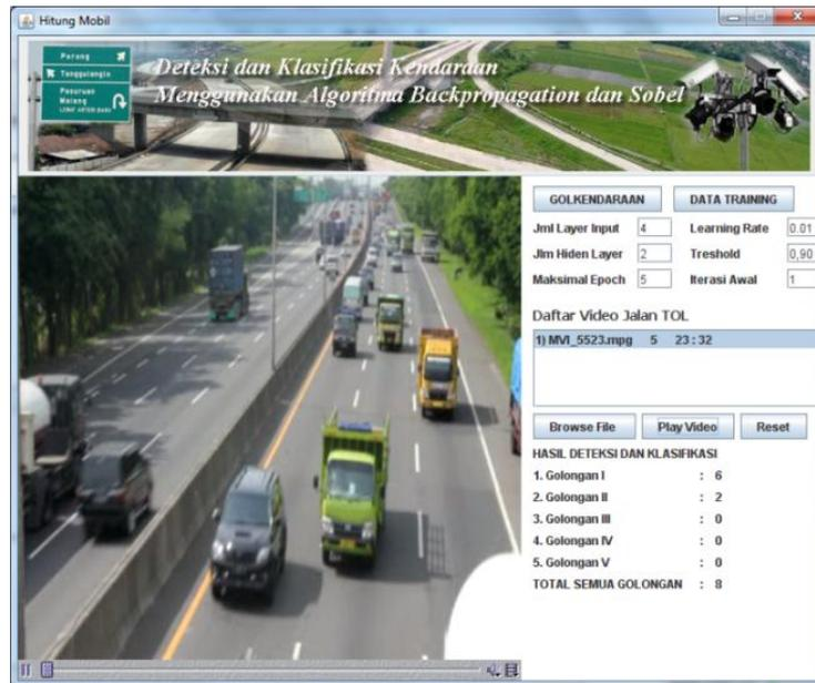
Gambar 4. Hasil pengujian klasifikasi golongan kendaraan dengan menggunakan metode *backpropagation* dan *sobel*
